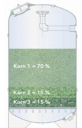
Bei kleinen Filtern (< 1'000 mm Durchmesser) kann anstelle von Korn 3 auch Korn 2 verwendet werden. Bei allen Filtern mit Düsenboden kann auf Korn 3 zu Gunsten von Korn 2 verzichtet werden.
