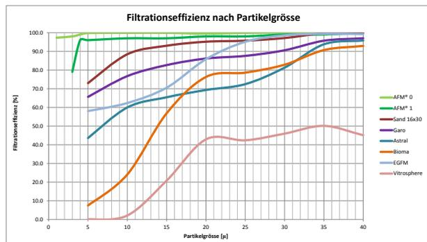
Die Fläche unter den Kurven steht für den ausgeprägten Schmutz und somit für das Filtrationsergebnis. AFM® filtert mind. 30 % mehr aus.
